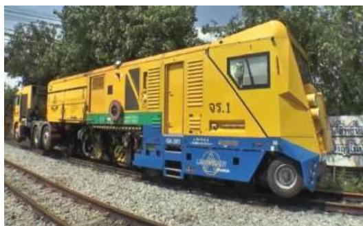
รถไฟทิ้งรถบรรทุกเจียรรางแบบ Milling (Rail Road Truck Milling) จากบริษัท LINSINGER Austria ประเทศออสเตรีย ที่ได้รับการส่งมอบในปี 2564 จำนวน 1 คัน ราคาประมาณ 493 ล้านบาท
